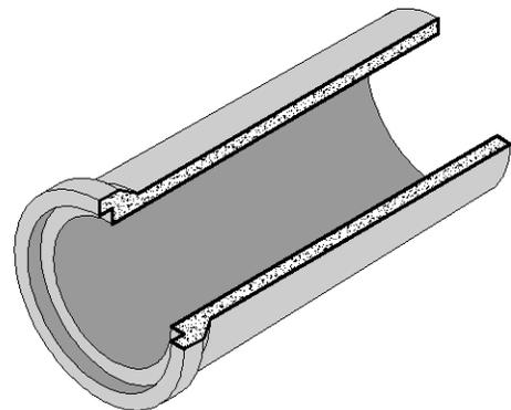
El tubo de concreto simple con junta normal ha sido la opción más económica y popular en nuestro país, su unión es con mortero y es una buena opción para drenajes pluviales. El tubo de concreto reforzado con junta normal es recomendado para drenajes pluviales, pasos de agua y alcantarillados para carreteras.
