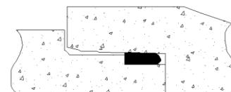
El empaque satisface y/o excede los requerimientos de Propiedades físicas de ASTM C-443 y NMX-C-412
